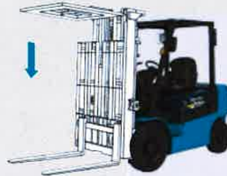
頑強れしやすい荷物を上から押さえ安全に運ぶ ロードスタビライザー
